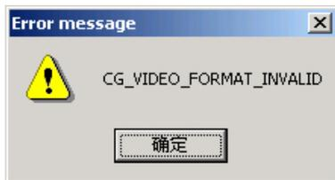
由于直接将图像采集到计算机屏幕上，这时图像卡的采集、显示的数据格式应与主机显示卡的显示模式中的“颜色”数保持一致。如显示卡的显示“颜色”数：256色，对应图像数据格式：Limited 8bit 或 All 8bit；32768色(15位)，对应 RGB555；65536色(16位)，对应 RGB565；16mil色(24位)，对应 RGB888；真彩色(32位)，对应 RGB8888。当这些设置不一致时，就会出现上述对话框。打开“Parameter ->Format”，选择正确的图像数据格式。
