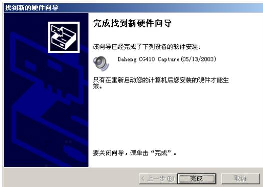
5. 重启计算机后，打开“系统”的“设备管理器”，找到“Daheng CG410 Capture(05/13/2003)”设备图标，查看图标上的日期标识和 CG410 的设备状态，用来确认驱动程序的安装是否成功。
