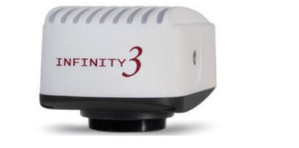
Lumenera 的 INFINITY3-6UR 是一款理想的通用型相机，它的分辨率高（600 万像素），色彩还原度好，采集速度和光灵敏度均适合低光应用。相机内置 Sony EXView HAD II 传感器技术，相机的动态范围高，像元尺寸为 4.54μm×4.54μm，噪声低。
